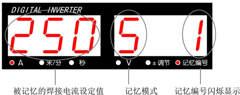
若被设记忆编号尚无记忆数据时, 如下图所示, 右侧显示表闪烁显示记忆模式代码及条件编号『S 1』, 左侧显示表闪烁显示『— — —』。记忆编号可用电压调节旋钮 (⑤) 设定。
