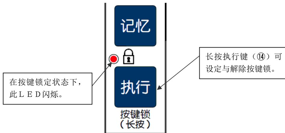
即使在按键锁定状态下，检气、点动及焊接条件记忆功能仍可使用。
