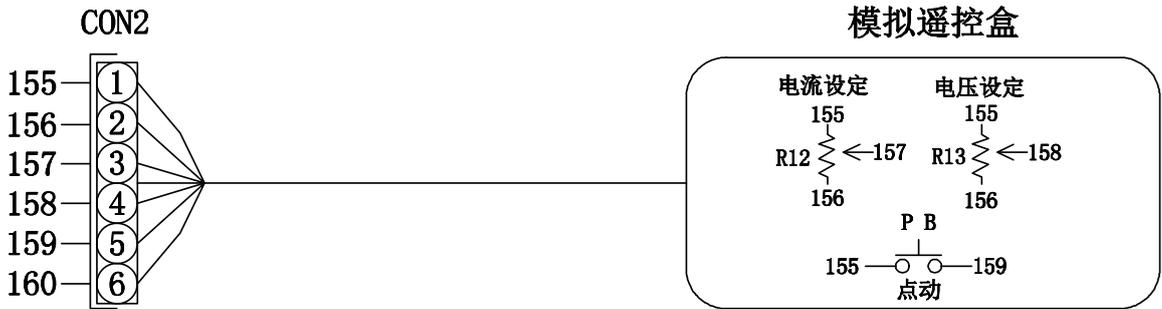
另外, 用外部电压信号进行电流、电压设定时, 需设置到「自动」模式「1」, 详情请参照「10.2.1 (4) 自动/半自动模式切换」。
