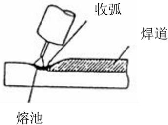
在焊接结束部位有残留凹陷。因为凹陷会引发裂纹或焊接缺陷，所以要尽量使其变小，这种处理称为收弧填弧坑。
