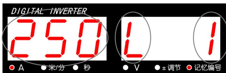
被记忆的焊接电流设定值      读取模式      记忆编号闪烁显示
