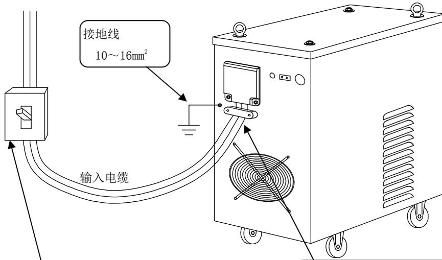
请为每台焊接电源逐一配备保险或空气开关。使用漏电断路器时，必须使用有CCC认证的正规产品。
