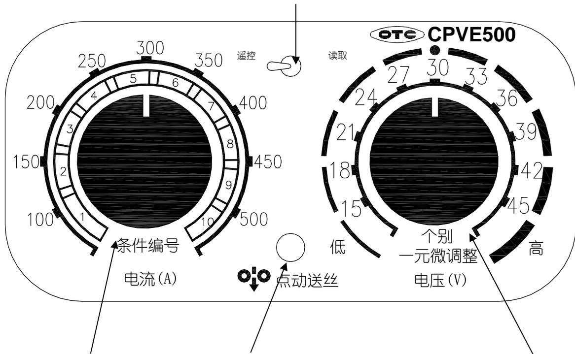
焊接电流设定旋钮
