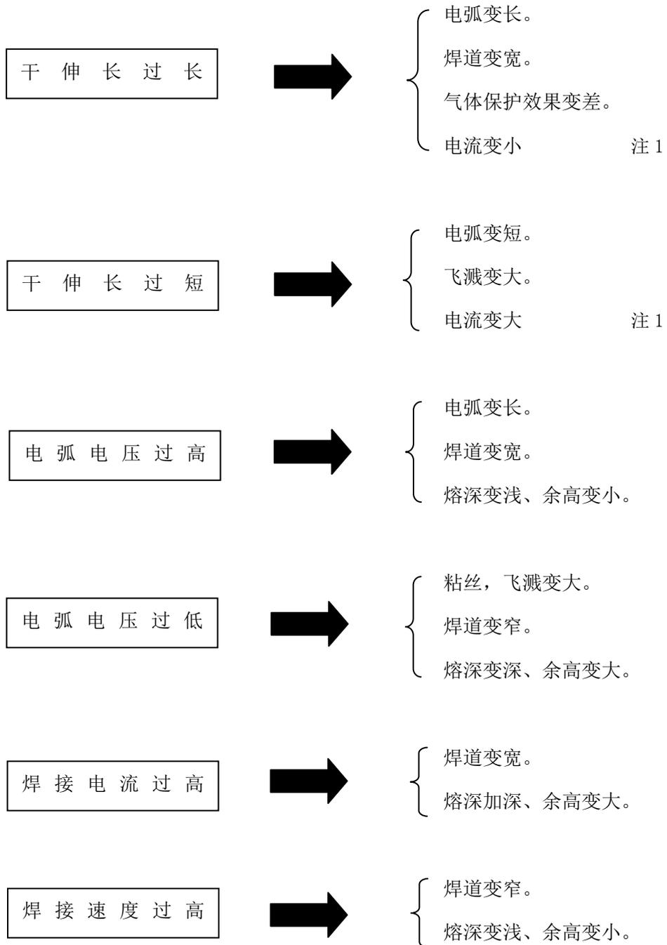
注 1: 用熔深控制功能 F13 可以改善设定电流与实际电流的差值。
