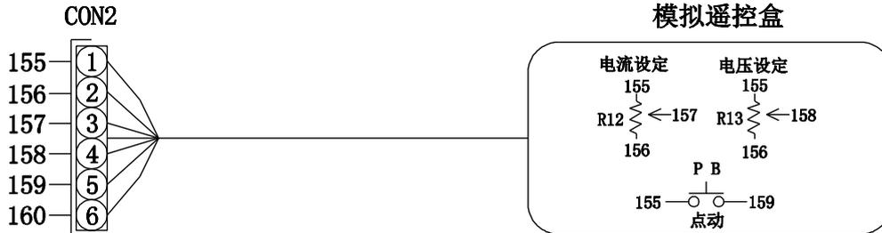
另外, 用外部电压信号进行电流、电压设定时, 需设置到「自动」模式「1」, 详情请参照「10.2.1 (4) 自动/半自动模式切换」。
