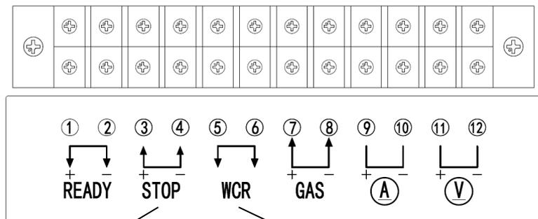
由外部输入动作停止信号时使用的端子。
