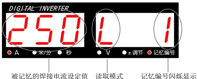
若被设记忆编号尚无记忆数据, 如下图所示, 右侧显示表闪烁显示读取模式代码及记忆编号『L 1』, 左侧显示表闪烁显示『— — —』, 此状态下可用电压调节旋钮 (⑤) 调节条件编号。
