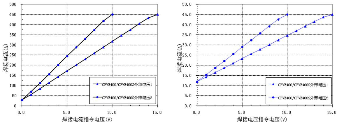
外部电压 1: F5 设为 OFF, 指令电压范围 0V~15V;
