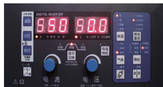
图1: 电流电压设定(可精确设定到1A和0.1V)
