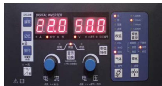
图2: 一键切换送丝速度显示
